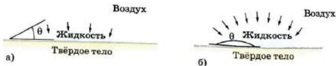
Рис. 5. Краевой угол на гидрофильной (а) и гидрофобной (б) поверхностях
