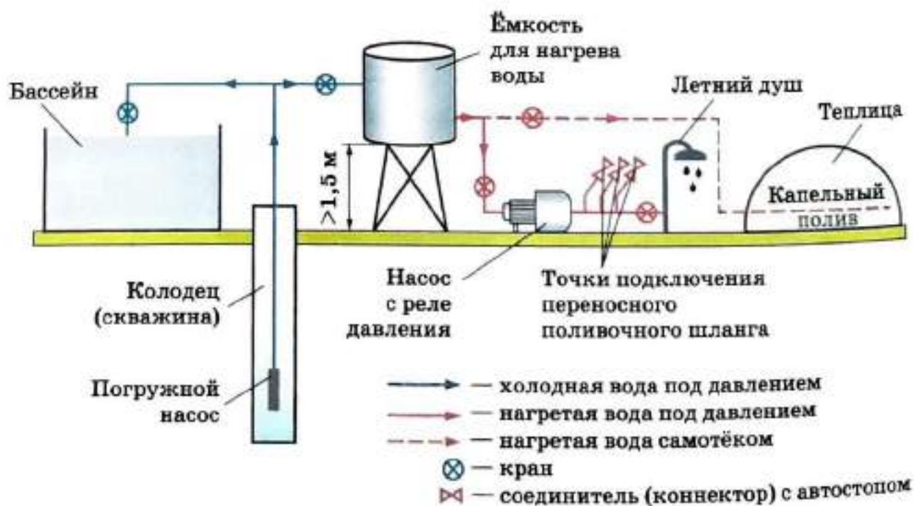
Рис. 18. Схема водопровода с подачей воды из скважины
